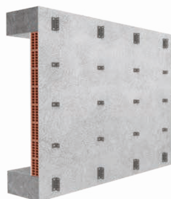
Replanteo y colocación de las ménsulas. Layout and fixing of the brackets and insulation. Implantation et fixation des supports. Разметка и монтаж кронштейнов.
