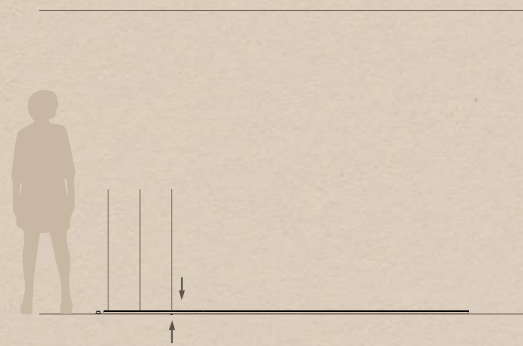
1 Installation of support profile and first row of rods. Instalación del perfil de apoyo y unión de la primera fila de varillas. Installation du profilé support et connexion de la première rangée.
